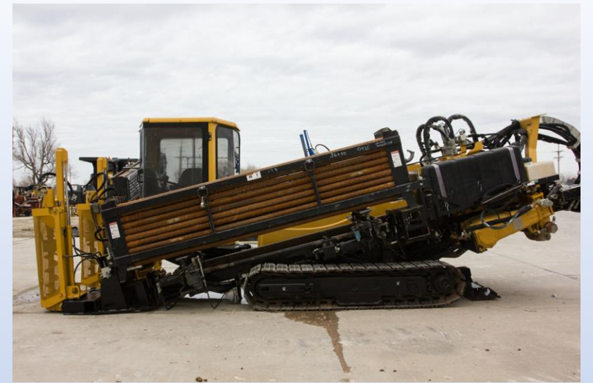
Горизонтально направленное бурение машиной Navigator
